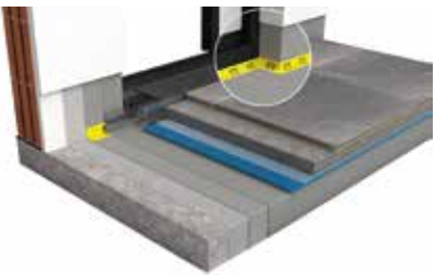
Übergang mit variablem Drainrost
